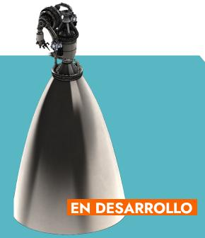
E2 del TII-250 (x1) Uso Empuje en VAC 4280 Kgf LOX/RP1 **Propelentes** Impulso espec. 366 S en VAC Ciclo generador de Sistema de alimentación
